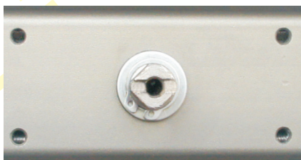
顶部连接尺寸符合VDI/VDE3845NAMUR标准，可安装限位开关(回讯器)和定位器等附件。
